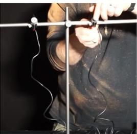
Con il laser a doppia croce l'altezza viene regolata tramite il giunto fisso, che serve come elemento intermedio tra le aste verticali e orizzontali. Stringere la vite zigrinata sull'asta verticale solo dopo aver raggiunto l'altezza desiderata.
